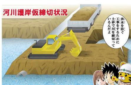
洪水を防ぐ工事をするために土砂で川を締切っているんだよ
