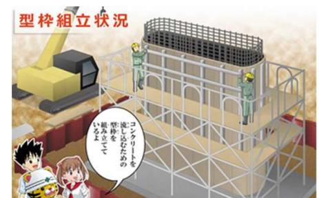
コンクリートを流し込むための型枠を組み立てているよ
