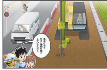
A-2 地中に杭を打って地盤を強くしているんだよ
